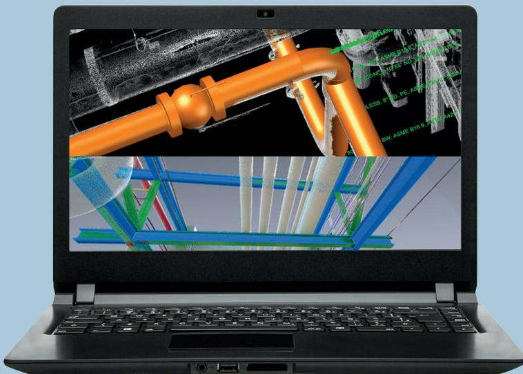
3D-Modell eines gescannten Rohrsystems, Typ-Erkennung und "best-fit" des Stahlbaus
