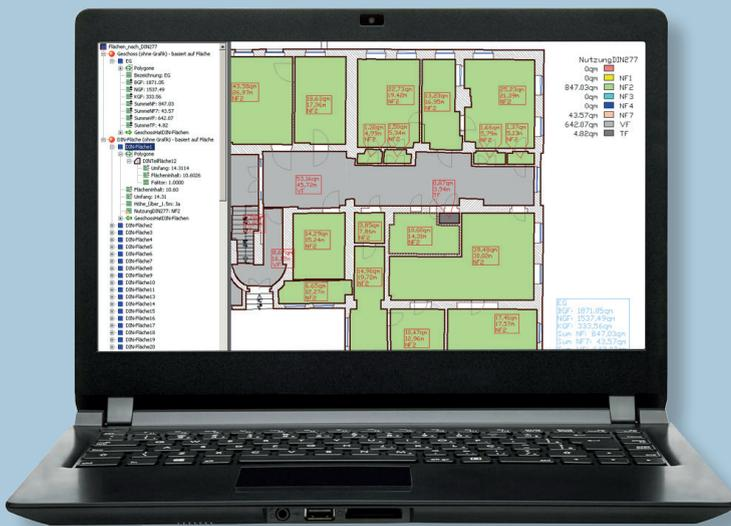
Mit TachyCAD eingemessener Grundriss. Geometrische Informationen zu einzelnen Räumen wie Fläche und Rauminhalt werden automatisch errechnet. Erfasste Sachdaten können Räumen zugeordnet werden.
